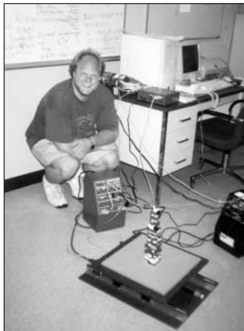
profesor Johnson a jeho zařízení na testování seismické odolnosti „mrakodrapů“ z Lega
