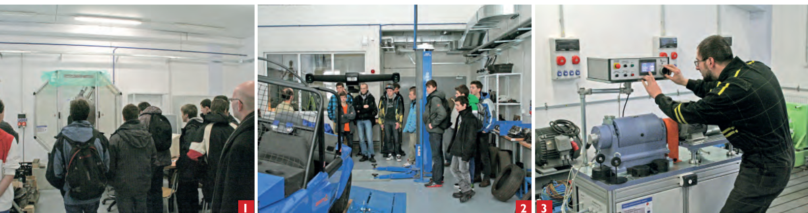
obr. 1 – instrumentované rázové kladivo (uprostřed) a univerzální zkušební stroj (vlevo); obr. 2 – prohlídka laboratoře KDPD se „students´ car“; obr. 3 – měření a regulace výkonu elektromotoru
